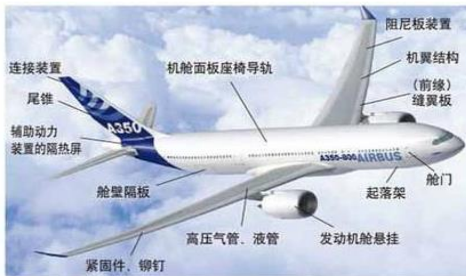
图12：钛合金在飞机上主要应用部位和部件
