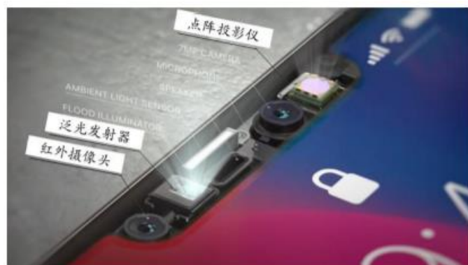
图表 33 iPhone X 的 3D Sensing 结构图
