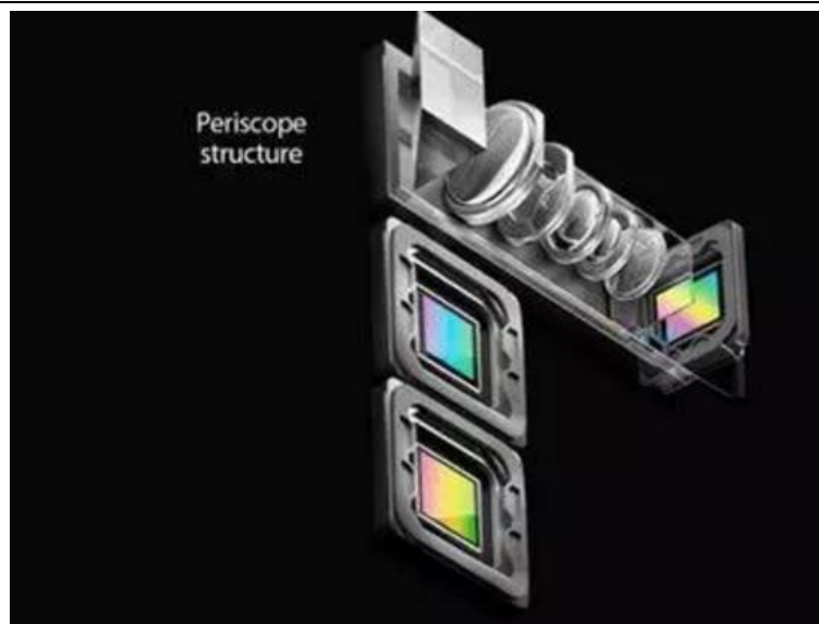
图表 35：潜望式摄像头内部结构
