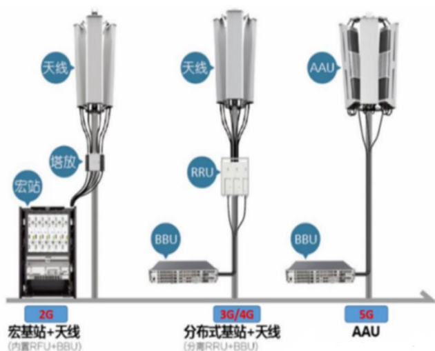
图 24 2G-5G 基站结构演变
