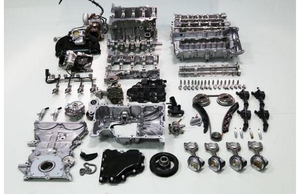
图表24: 上汽 SGE 系列发动机拆解图
