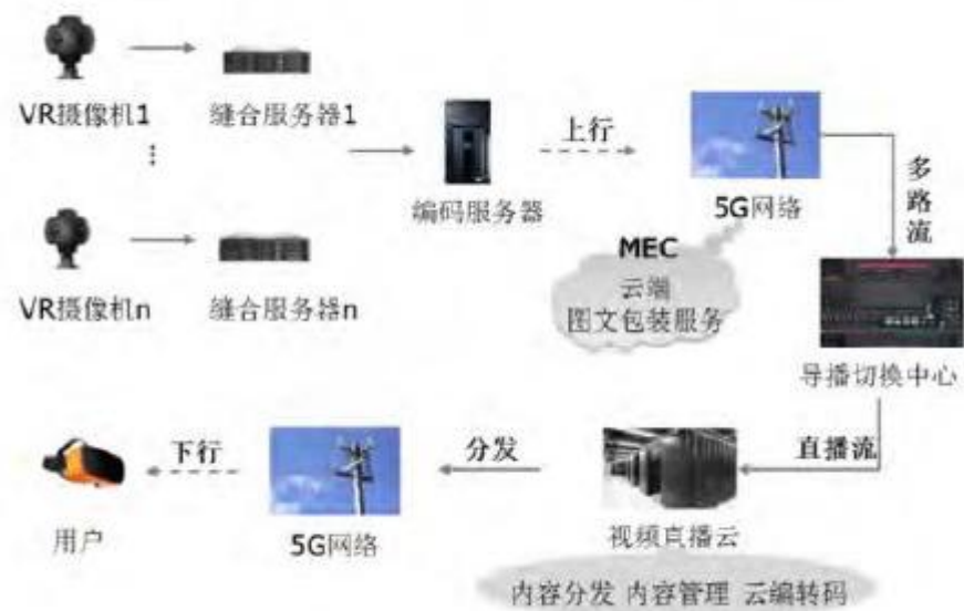
图 51：5G+VR 的制作架构
