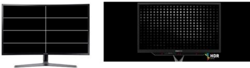
图 3：区域调光技术对比：直下式分区数量远大于侧入式
