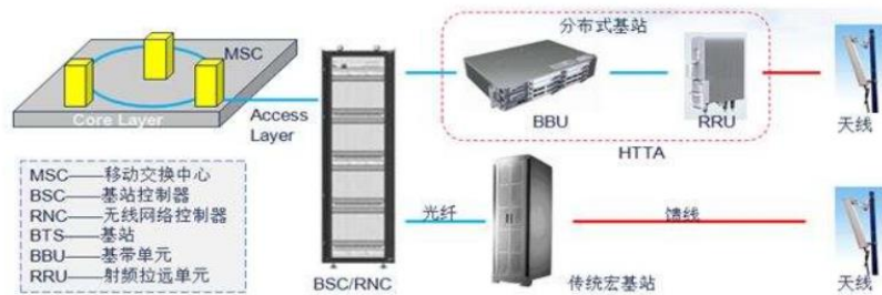
图表64 分布式基站与传统宏基站结构图
