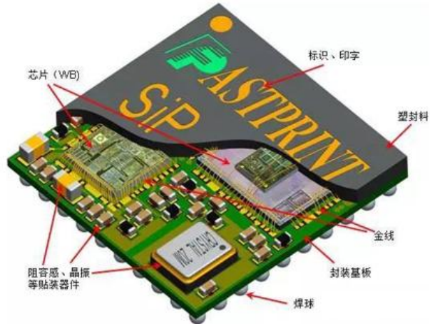
图表 9: 多芯片 SiP 封装结构示意图
