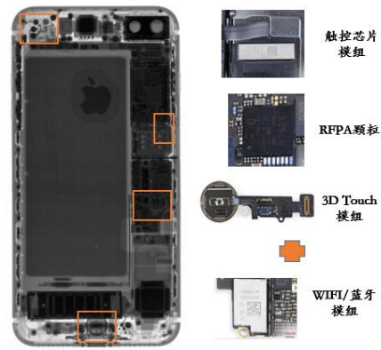
图表 12: iPhone 7 plus 内部 SiP 模组渗透增大
