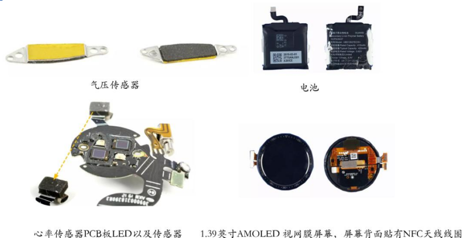
图表 27: 华为 watch GT 零部件拆解
