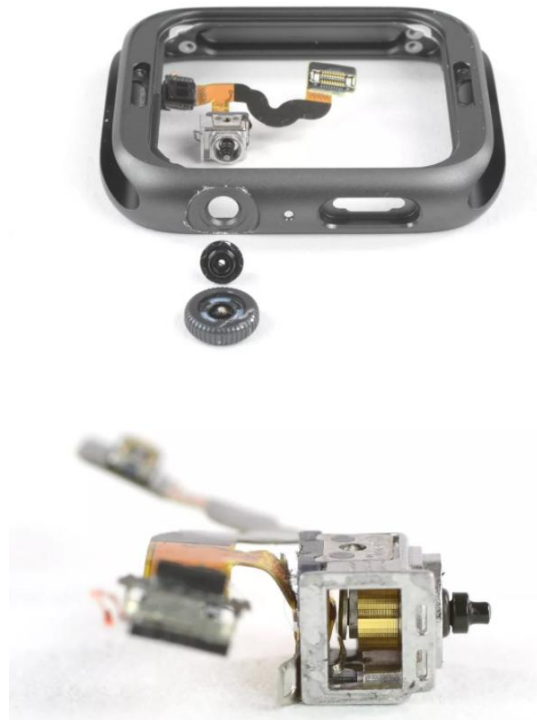
图表 18: Apple Watch 全新电极式心脏传感器
