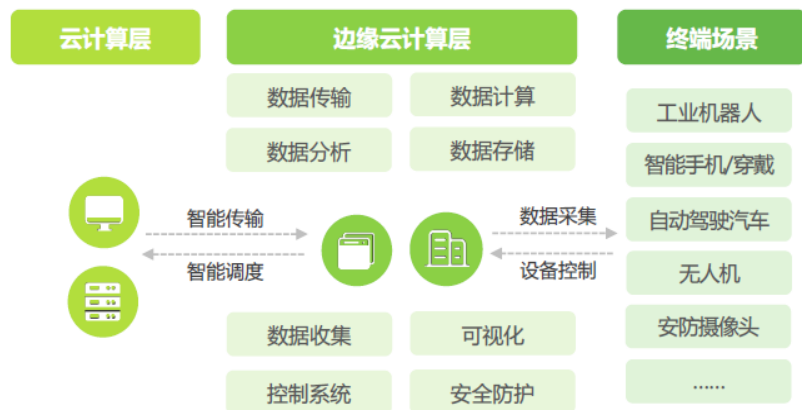
图表35：边缘云计算结构的部署模式与通用场景
