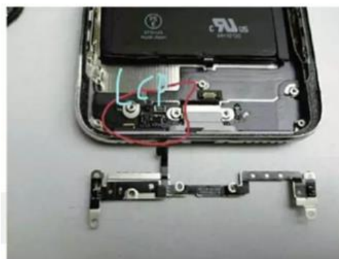
图 3-12：iPhoneX 的低损耗 LCP 基材下的天线设计
