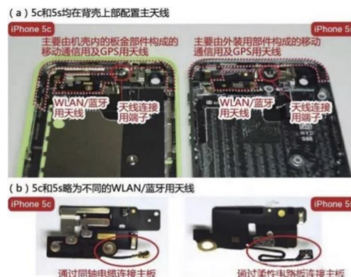
图 3-6：iPhone5C/5S 内部主天线结构
