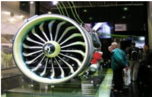
图表 161: 新一代 Leaf 涡扇发动机碳纤维风扇叶片
