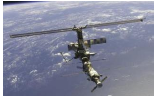
图表 162: 国际空间站巨大桁架由碳纤维复合材料制成
