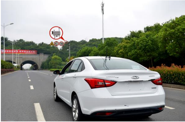
图表117. 奇瑞汽车 V2X 示范道路安装的 RSU 路侧设备
