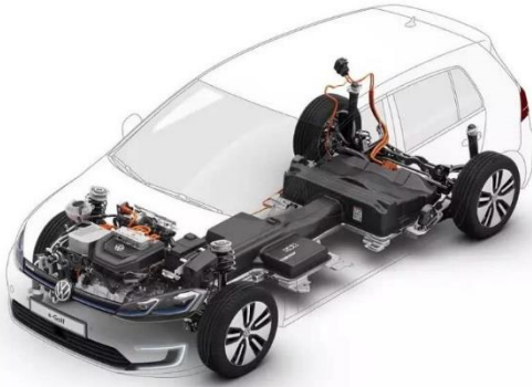
图 34 基于大众 MQB 平台打造的 e-Golf 底盘布局
