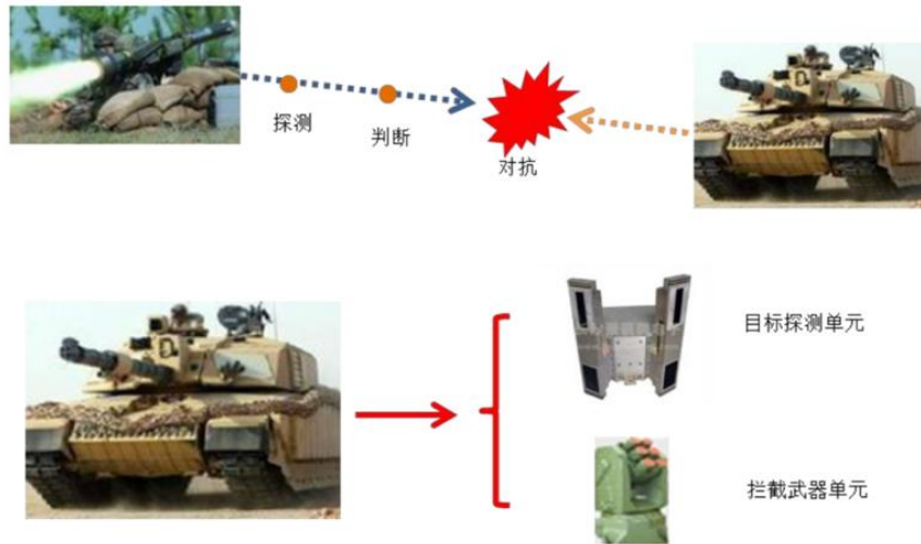
图表16. 主动防护雷达系统工作原理
