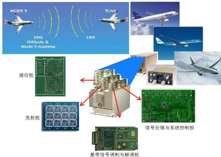
图表17. 空中防撞系统工作原理
