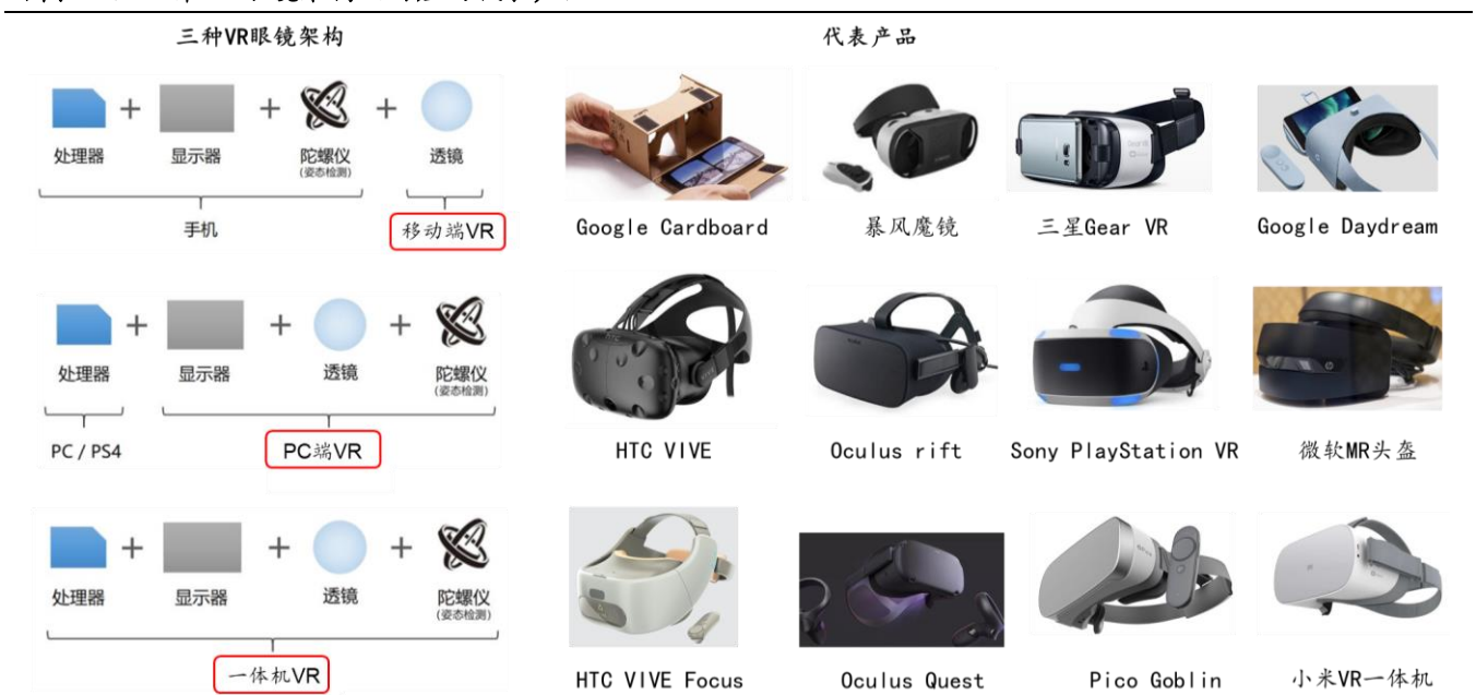
图表 5：三种 VR 眼镜架构及对应的代表产品
