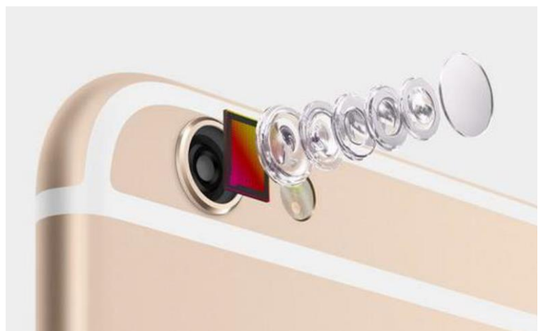
图 26：苹果 6 使用 5P 镜头导致镜头向外凸起
