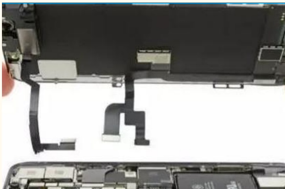
图表 38: LCP 天线在手机中的应用
