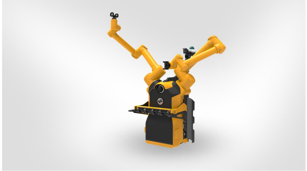
图 67: 亿嘉和 2019 年推出的战略产品室外带电作业机器人
