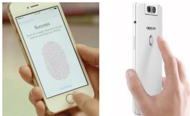
图 15：正面式、背面式电容指纹识别
