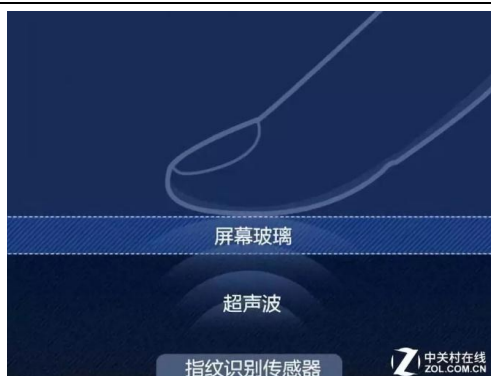
图 17: 超声波式屏下指纹识别原理
