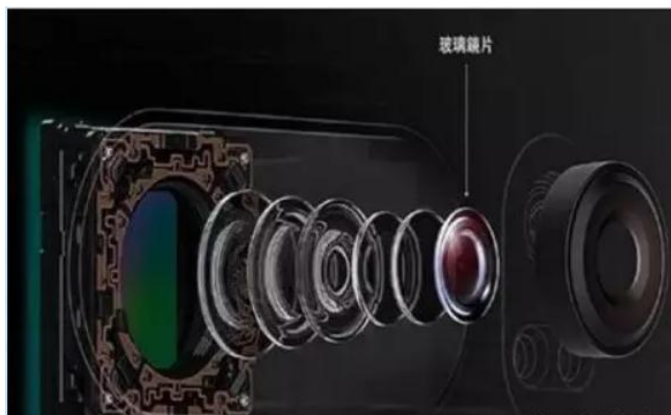
图 48：玻塑混合镜头示意图
