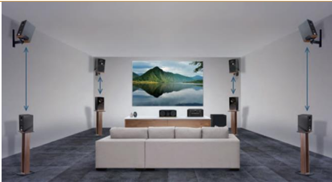
图 16: Auro-3D 扬声器已于安装，且向下兼容 5.1 环绕声
