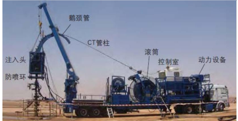
图 55: 连续油管设备主要部件
