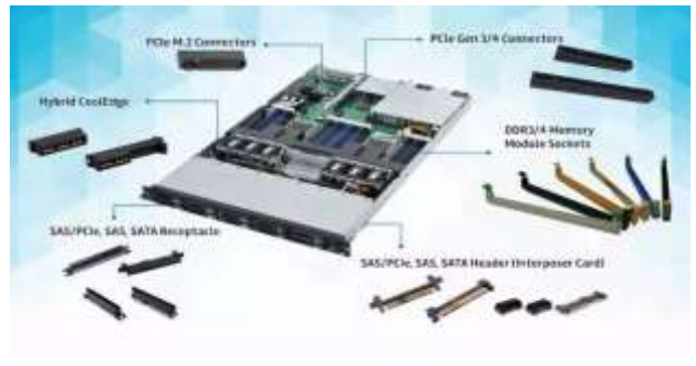
图 16: 安费诺高速服务器互连方案
