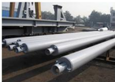
钻采设施防腐
