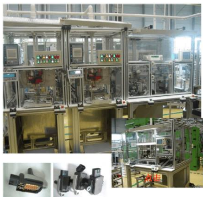
图表 2: 汽车发动机点火线圈装配测试生产线
