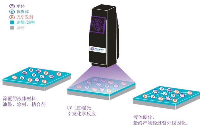
图 13：紫外光固化原理
