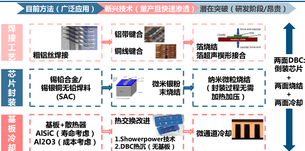
图 48：IGBT 模块技术在键合工艺、封装、基板等方面的升级趋势
