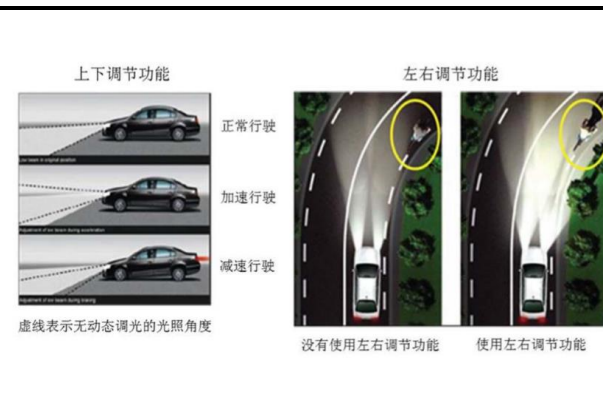
图表42. LED 主光源控制器使用效果
