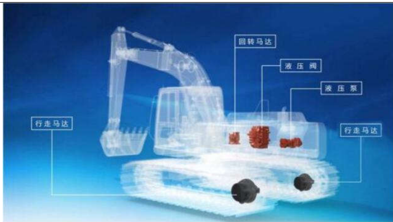
图 12：液压系统在挖掘机中的情况
