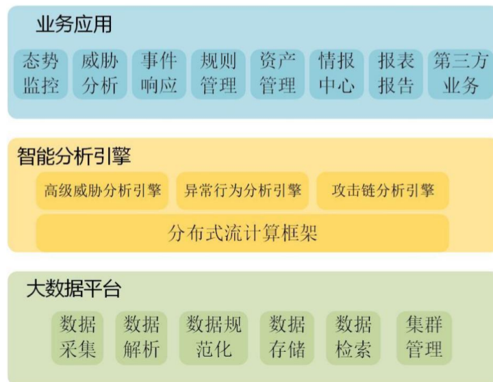
图 21：网络安全大数据分析平台总体架构
