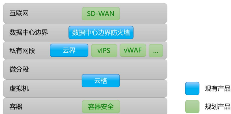
图 22：云安全系列产品在多层级云服务上的部署位置
