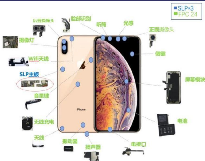
图 34、iPhoneXs Max 电路板使用情况
