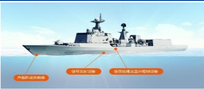
图表 1：水声信息传输装备在水面舰艇中的应用示意图
