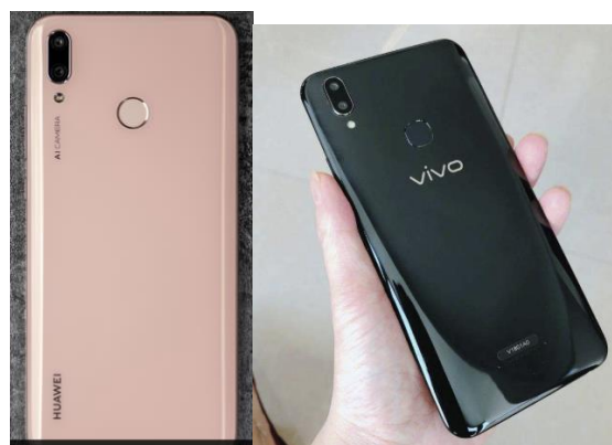
图9：PC/PMMA 复合板材后盖外观与玻璃类似
