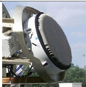
F-35 机载 AN/APG-81 有源相控阵雷达
