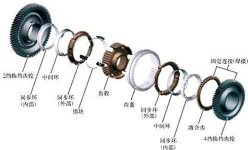
图 8: 汽车变速器用同步器主要配件
