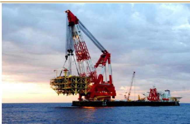
图 2：世界第一单吊 7500 吨起重船“蓝鲸”
