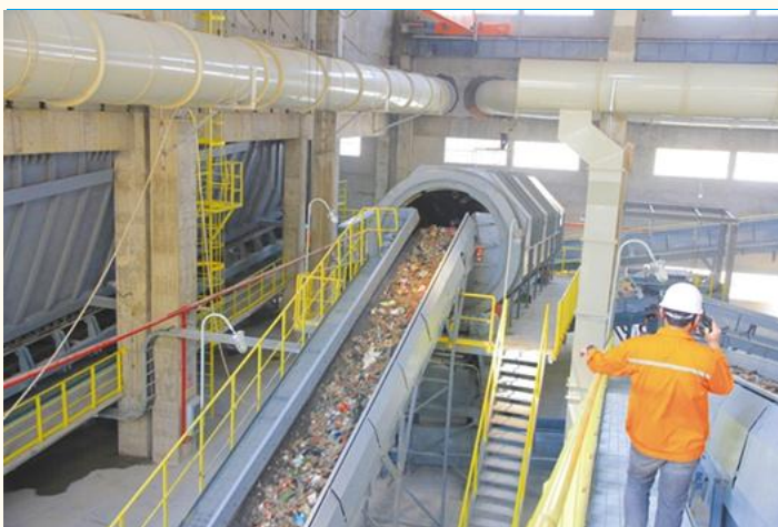
图表 45：正在处置城市垃圾的水泥熟料生产线
