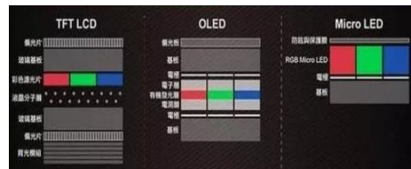
图 38: TFT-LCD、OLED、Micro LED 显示原理对比
