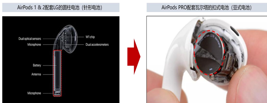
图 22: AirPods PRO 配套 VARTA 的扣式电池
