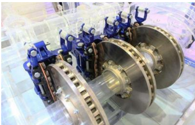
图 38：闸片与制动盘组成一对摩擦副
