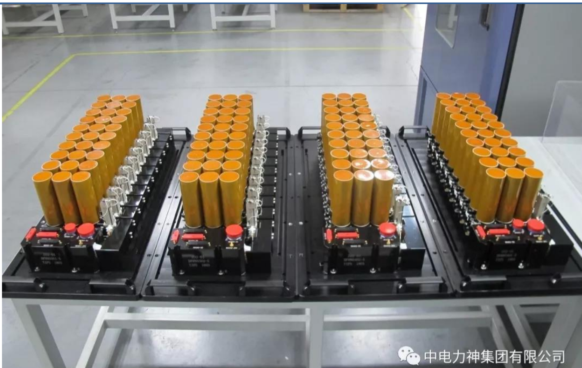
图 7：实践二十号卫星采用中电科 18 所的全新锂离子蓄电池组
