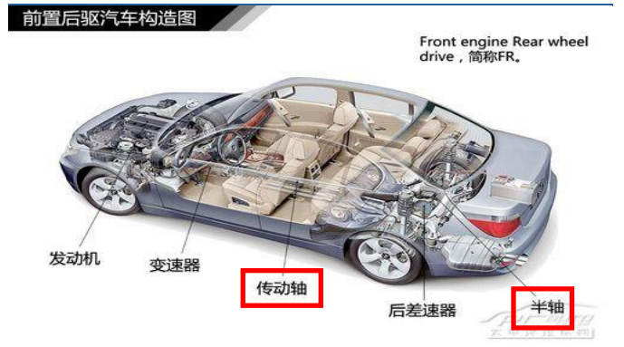
图 34: 前置后驱传动系统结构
