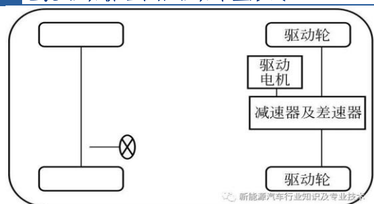
图 38: 电机-驱动桥组合后驱动布置形式
