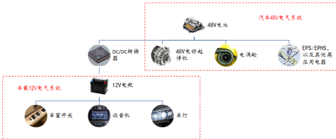
图 32：12V 电池为低负载零部件供电，48V 电池为高负载部件供电
