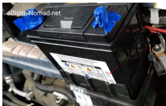
图 4：启动电池（低压电气系统）
