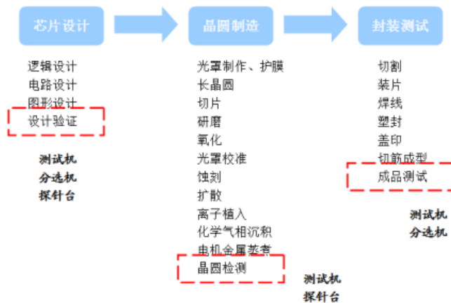
图9: 测试设备包括测试机、分选机、探针台三部分
