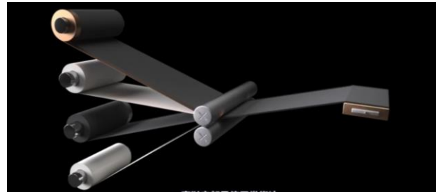
图19: 卷绕工艺将正负极片与隔膜卷绕成电芯
