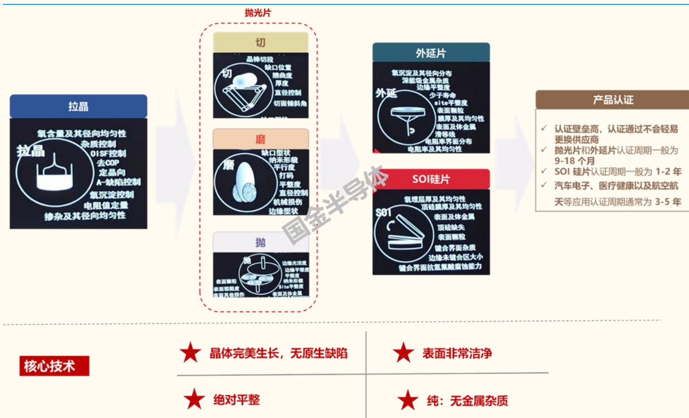
图表 25：大硅片生产工艺以及核心技术
