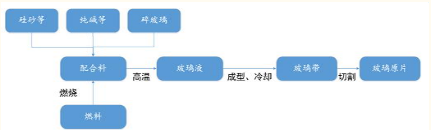
图表 3：浮法玻璃生产工艺主要包括燃烧、成型、切割等步骤
