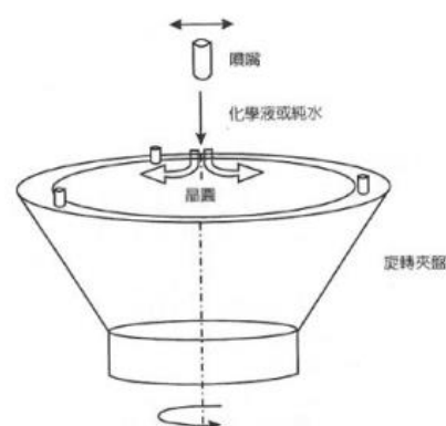
图 35：单片式清洗设备原理
