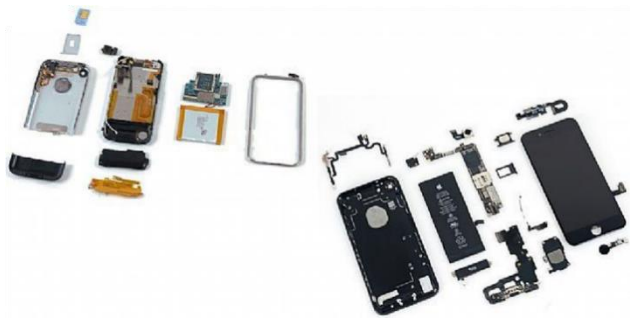
图 14:消费电子精度持续提升(一代 iPhone 和 iPhone 7 拆解对比)
