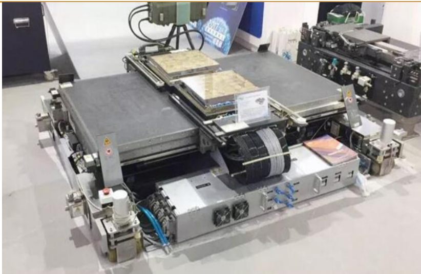
图 28：华卓精科双工件台样机打破 ASML 垄断
